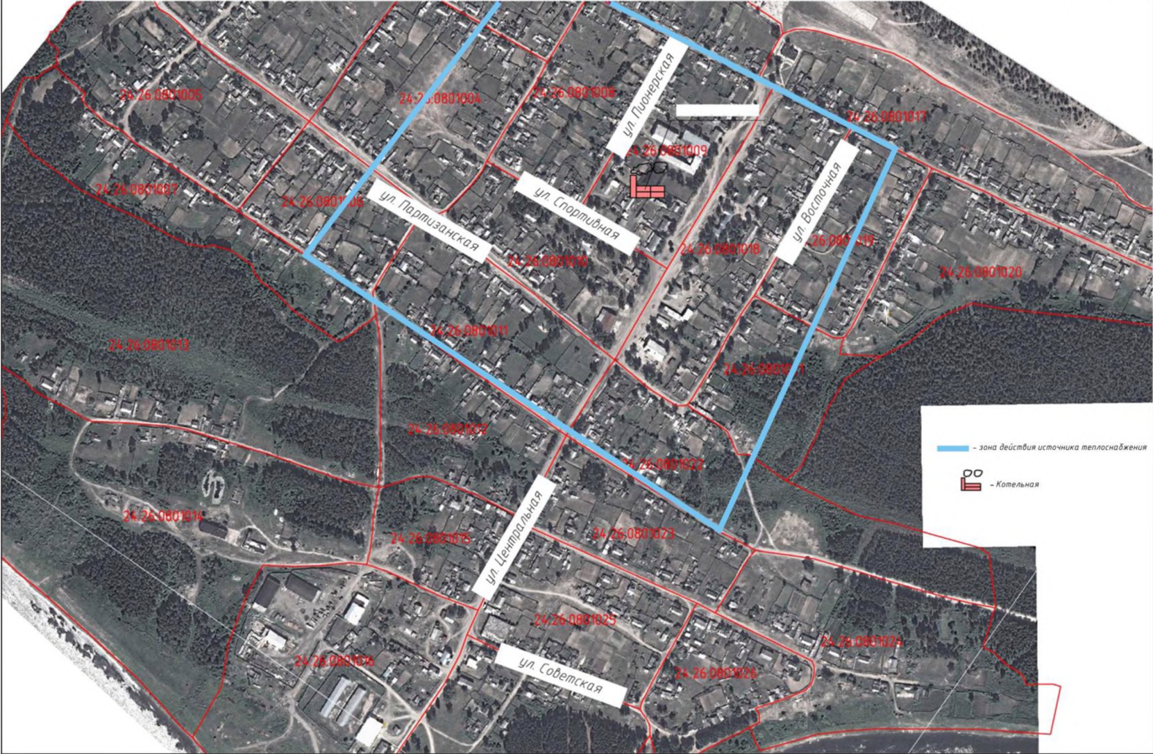
Схема расположения существующего источника тепловой энергии и зона его действия
